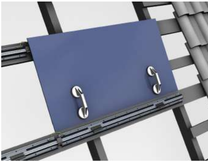
Abb. 8.7.1: Absetzen des Moduls zum elektrischen Anschluss
