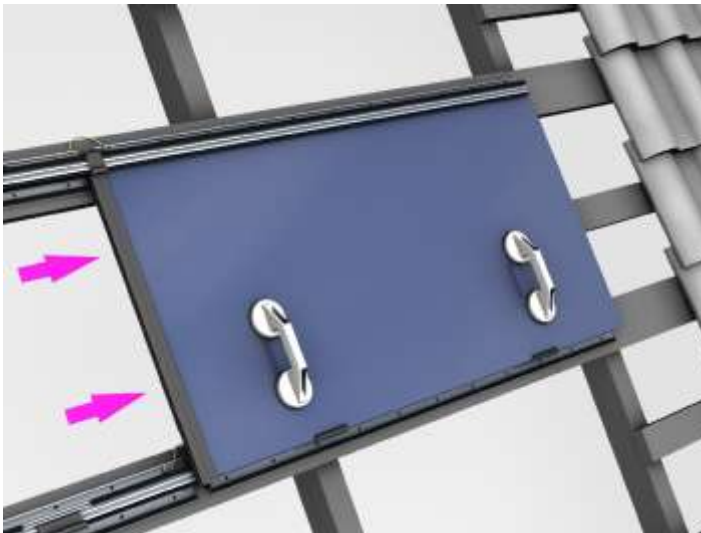
Abb. 8.7.4: Einsetzen des Dichtprofils
