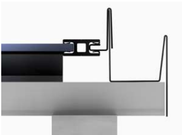
Abb. 8.8.25: Anbindung an einen Ortgang aus Blech
