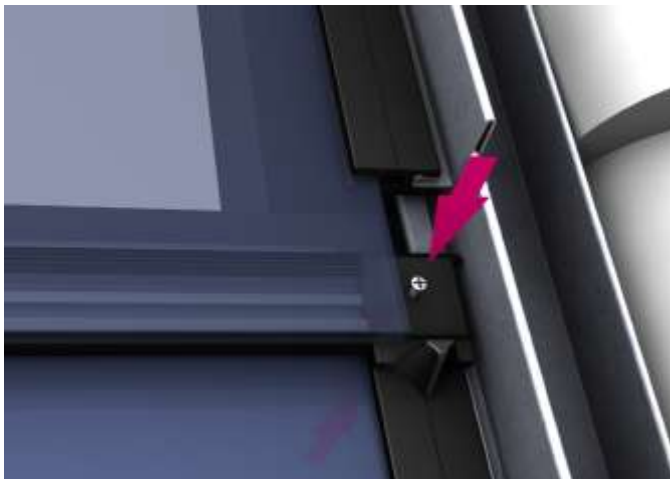
Abb. 8.8.20: Fixieren des seitlichen Kreuzstückes mit Schraube
