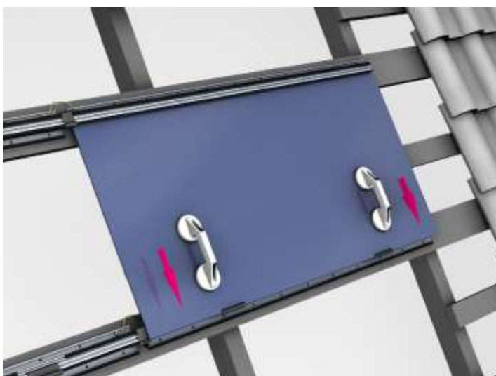
Abb. 8.7.3: Herunterziehen des Moduls in die Haltklammern
